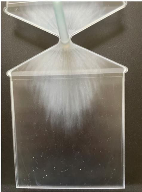
Abb. 2 Marktbegleiter: Schlieren nach Anwendung und zusätzlichem Nachspülen mit PMMA.
