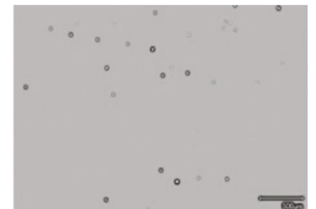
图5, 6: 显微照片展示了添加CEVO®-process B-3680后对高密度聚乙烯中2%炭黑块料分散性的影响。左图为不含添加剂的情况; 右图为添加0.5%添加剂的情况。
