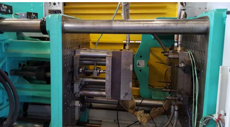
图1：用于注塑模具系统的夹紧装置/ 集成测力传感器（从左到右）
